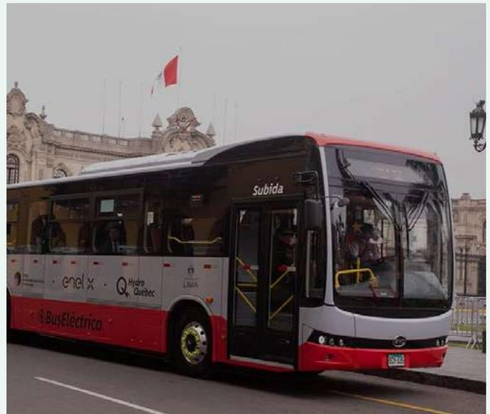
Por otro lado, el estudio comprobó que el e-bus emite menos ruido frente a los buses diésel. La reducción del ruido se produce tanto al interior como en el exterior del bus: durante la aceleración hay una reducción de ruido de 6 dBA, mientras que los pasajeros pueden experimentar una reducción del ruido interior de hasta 10 dBA.
